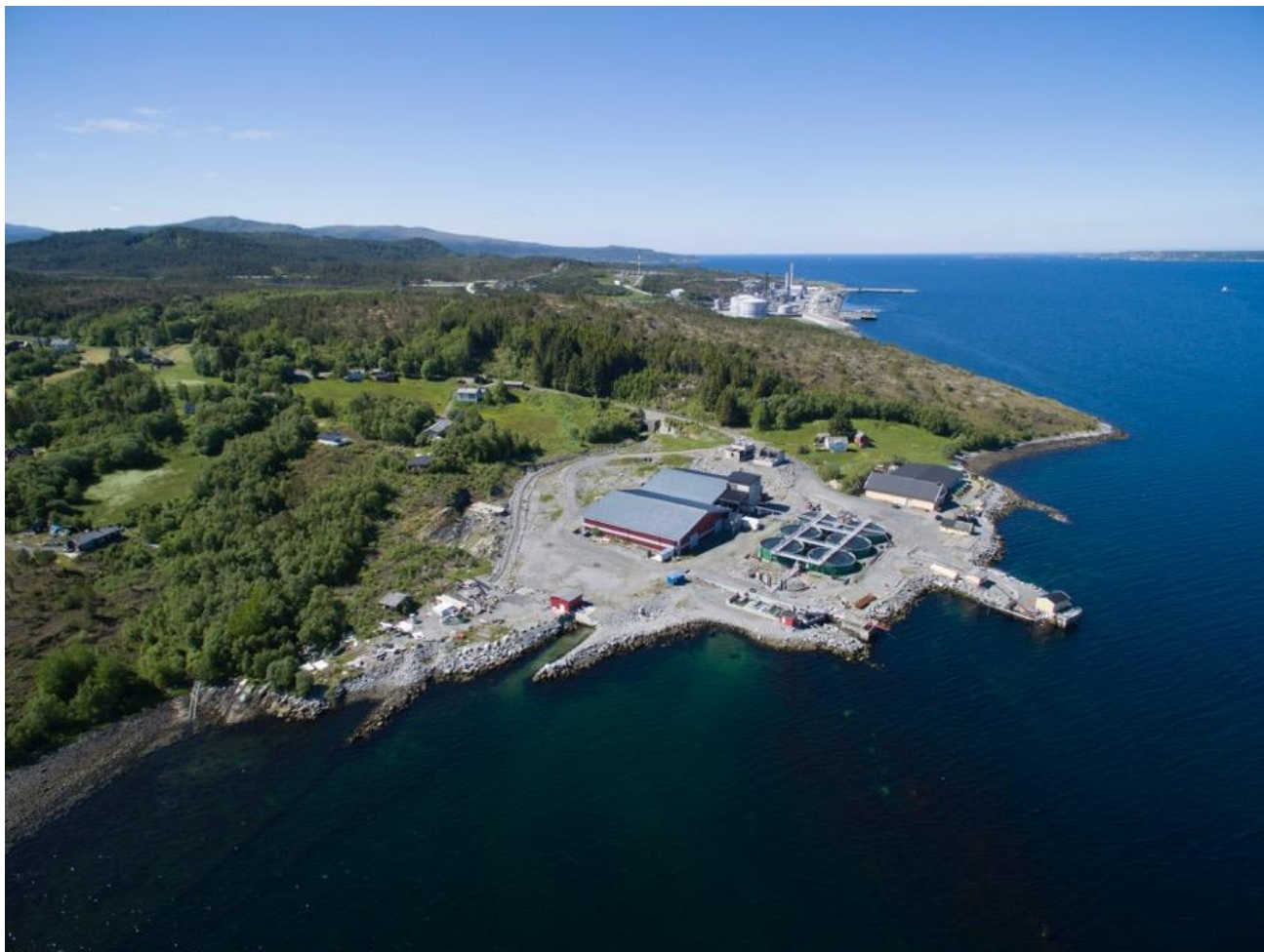
Kjølevann fra metanolanlegget transporteres i rør og tunnel for bruk i landbasert oppdrett. Biopark Tjeldbergodden midt i bildet.
